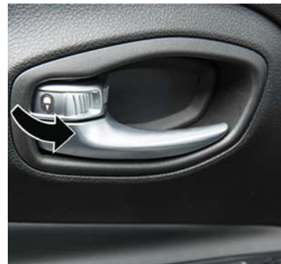
Manual Door Lock
