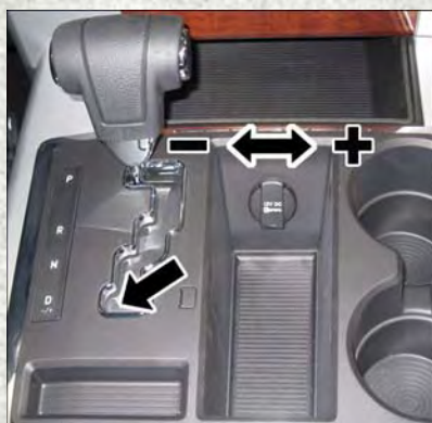
ERS Control Position
