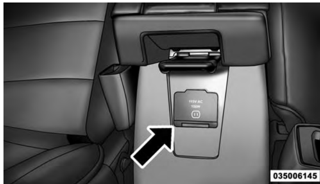
115 Volt Power Outlet
