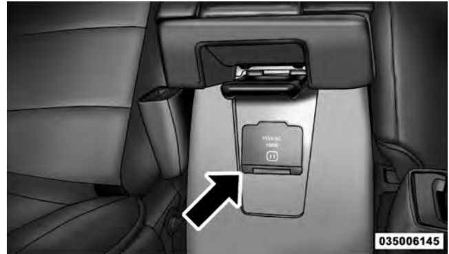
115 Volt Power Outlet
