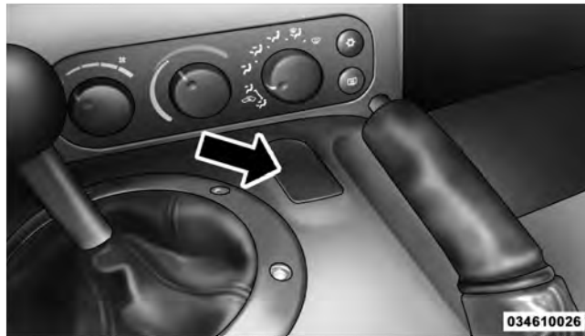
12 Volt Power Outlet
